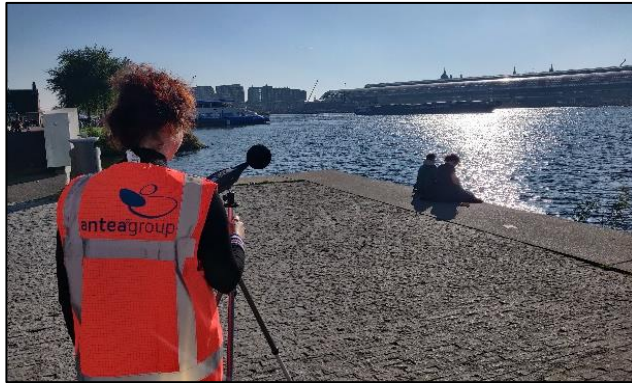
Figuur 3.1: Meting van de geluidseigenschappen door Antea Group ter hoogte van A'dam Toren
